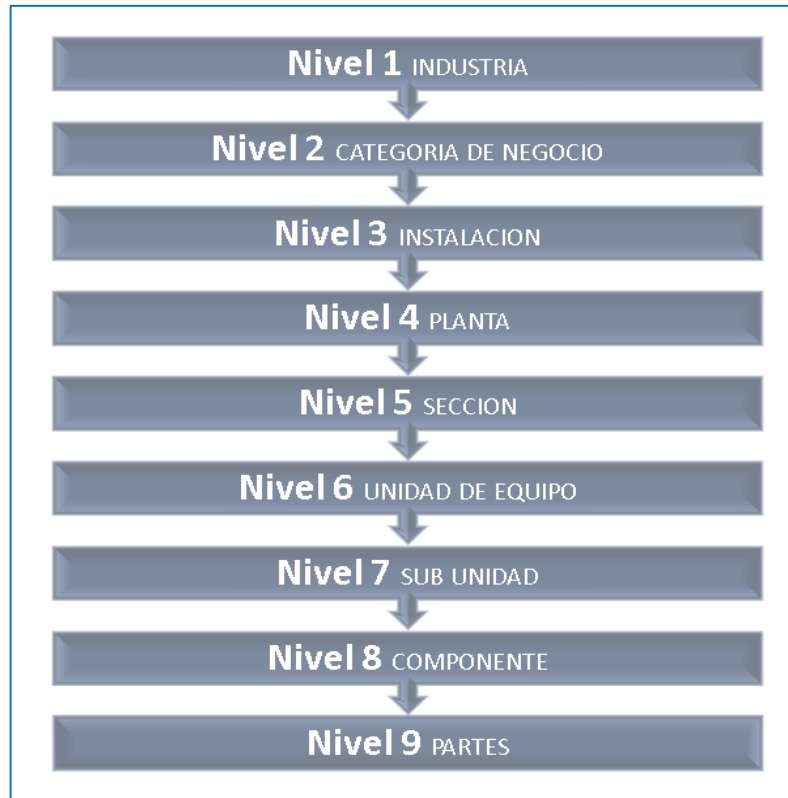
Figura 25: Niveles de Estructura de una Planta Industrial Fuente: (Norma ISO 14224,2015)
