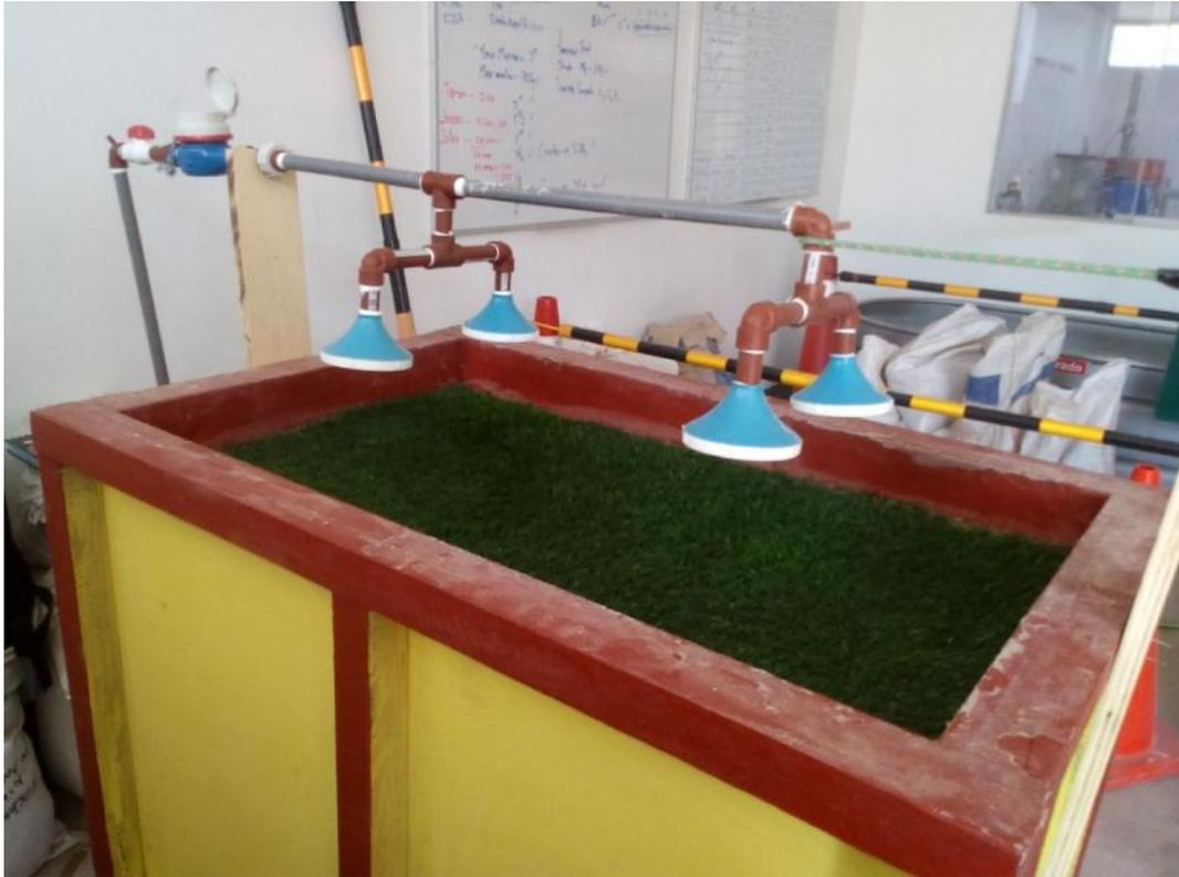
*Figura 23:* Modelo en laboratorio con rociadores simuladores de precipitación.
