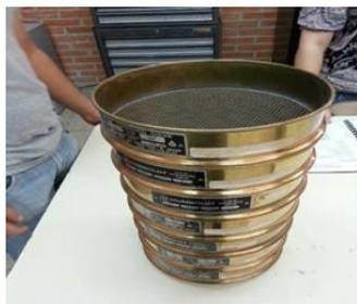
*Figura 4. Instrumentos para análisis de granulometría*
