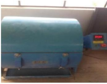
Figura 9. Prueba de resistencia de agregados menores por fricción.
