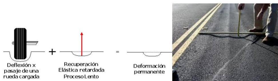
Figura 1. Deformación permanente (ahuellamientos)
