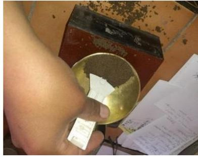
Figura 7. Pase a estado elástico o líquido
