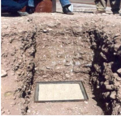
Figura 49. Ensayo reemplazo de arena.
