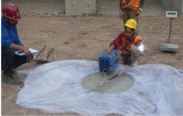
Figura 50. Ensayo reemplazo de agua.
