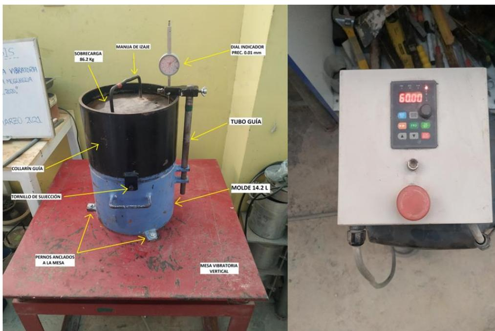
Figura 86. Instrumentos para realizar el ensayo de mesa vibratoria.
