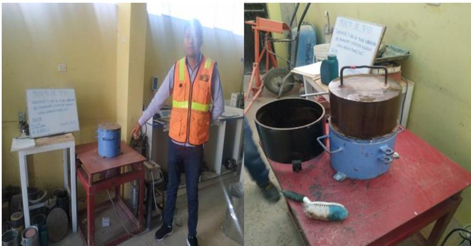
*Figura 87.* Colocación de molde con muestra a la mesa y sobrecarga.
