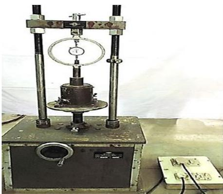
*Figura 33.* Prueba de compactación estática.
