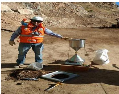
Figura 47. Ensayo cono de arena 12".
