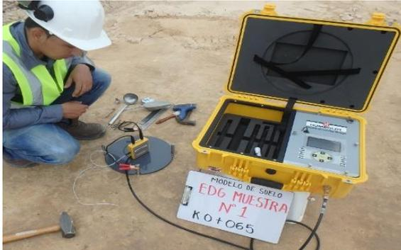
Figura 52. Densímetro eléctrico (EDG)
