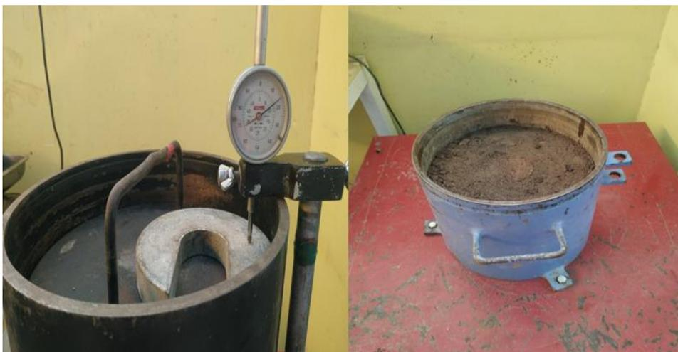
Figura 91. Vibración, toma de lectura y visualización del material asentado después del ensayo.
