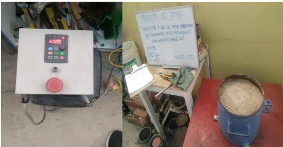
Figura 89. Visualización del asentamiento de la muestra después de la vibración.
