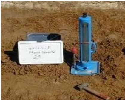
Figura 48. Ensayo de Balón de hule.
