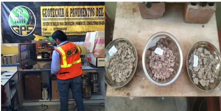
Figura 77. Determinación del contenido de humedad.
