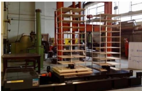
*Figura 56. Mesa vibratoria sísmica.*
