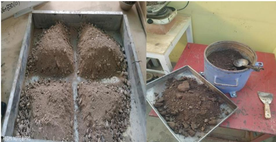
Figura 90. Preparación de muestra y llenado de material al molde.
