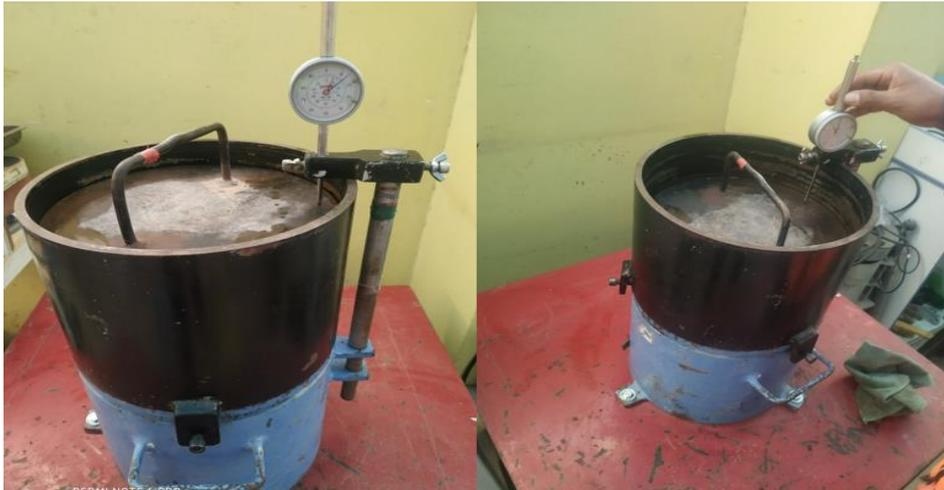
Figura 88. Toma de lectura inicial y después del vibrado.
