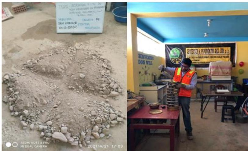
Figura 73. Cuarteo de muestra y análisis granulométrico
