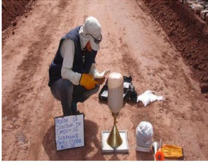
Figura 46. Ensayo cono de arena 6".
