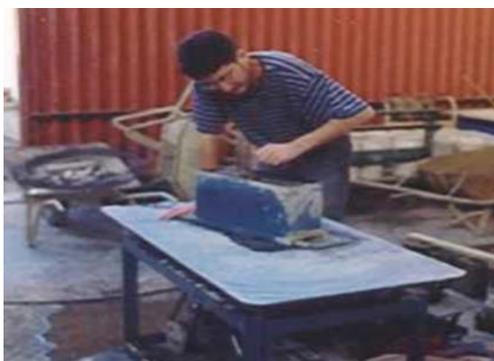
*Figura 58.* Mesa vibradora para bloques de concreto.
