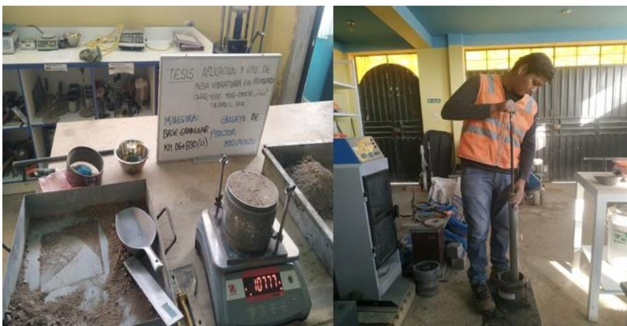
*Figura 82. Ensayo Proctor modificado ASTM D1557.*
