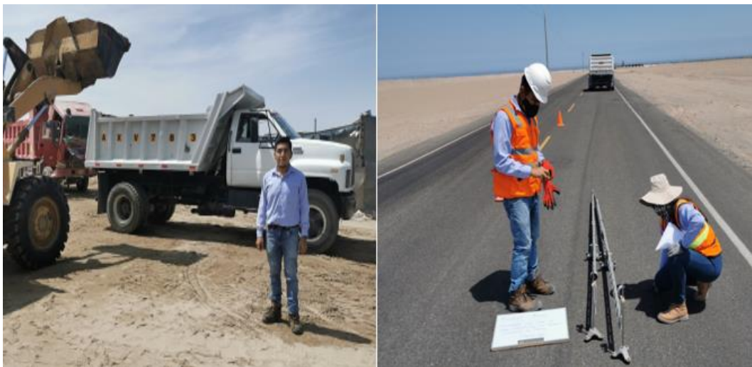
Figura 35. Preparación para evaluación de deflexiones con viga Benkelman - Tramo II - Los Palos - Tacna 2021.
