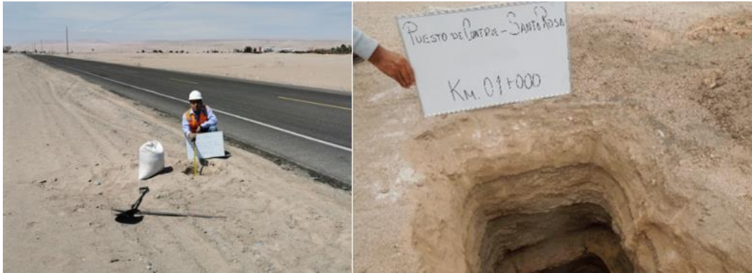
Figura 34. Apertura de puntos de exploración y toma de muestras para estudio del material.
