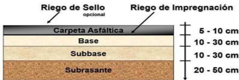
Figura 3. Corte transversal del pavimento flexible
