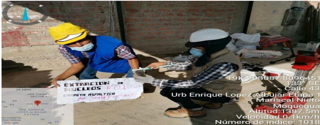
Figura N 17 extracción del núcleo del pavimento
