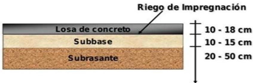
Figura 5. Corte transversal de un pavimento de concreto o rígido
