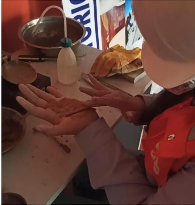
*Figura 31.* Ensayo de Límite Plástico.
