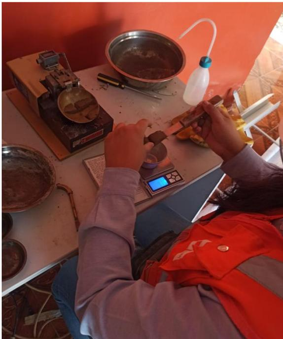
*Figura 30.* Ensayo de Límite Líquido.
