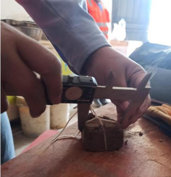
*Figura 33.* Toma de dimensiones – Ensayo Peso Específico.
