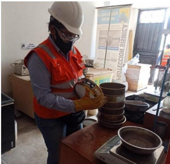
*Figura 29.* Ensayo de Granulometría – Pesos por Retenidas.
