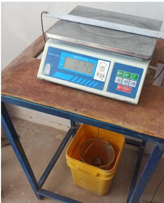
*Figura 34.* Peso Específico con Parafina.
