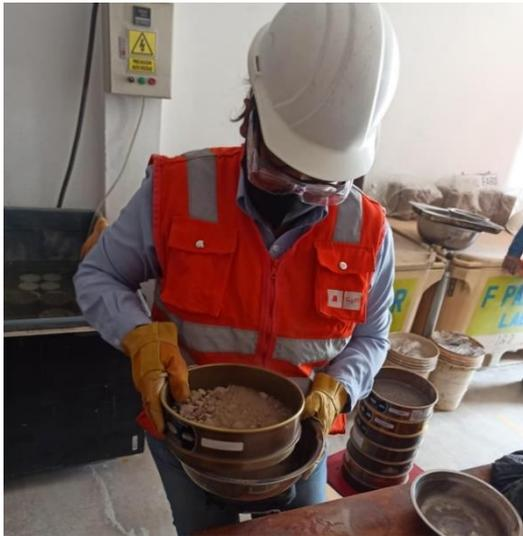
*Figura 28.* Ensayo de Granulometría – Tamizaje.
