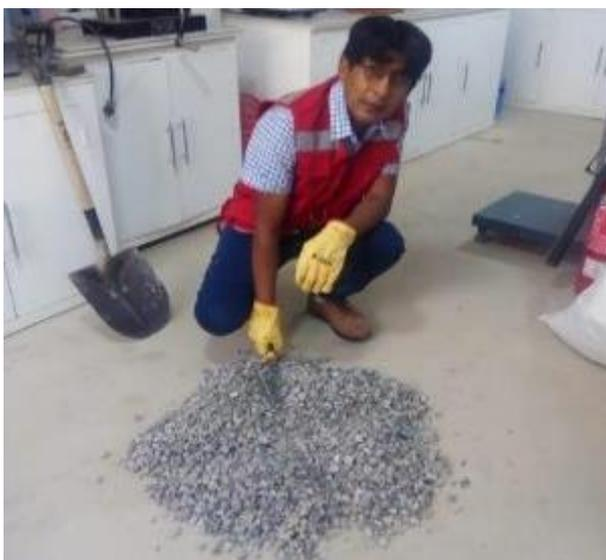
*Figura 28.* Cuarteo del agregado grueso en laboratorio
