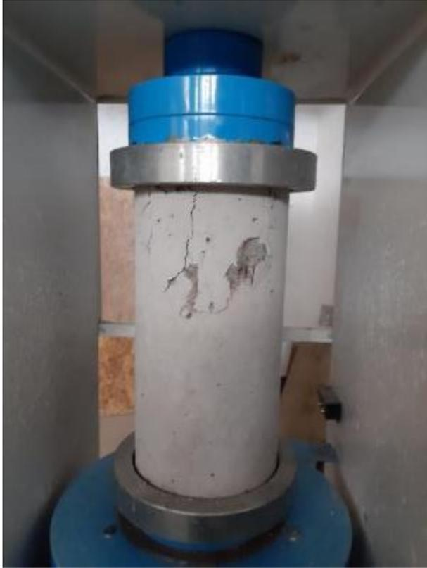
*Figura 20.* Visualización de rotura de acuerdo a las edades planteadas del concreto  $210 \text{ kg/cm}^2$  y determinación de fallas
