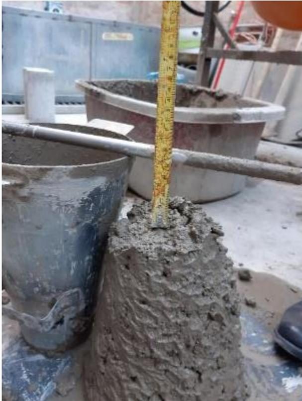
Figura 21. Prueba de revenimiento de 3" a 4"
