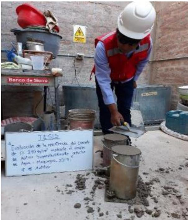
Figura 23. Preparación de los testigos de concreto 210 kg/cm<sup>2</sup>
