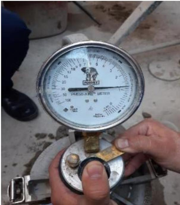
Figura 24. Se verifica el contenido de aire siguiendo las normas del NTP y ASTM
