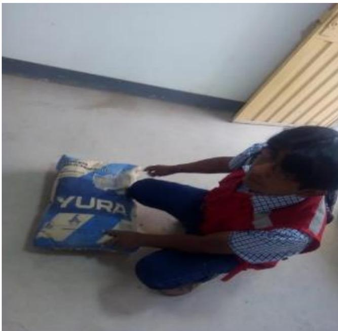
*Figura 14.* Cemento que se usa para el diseño yura 1p
