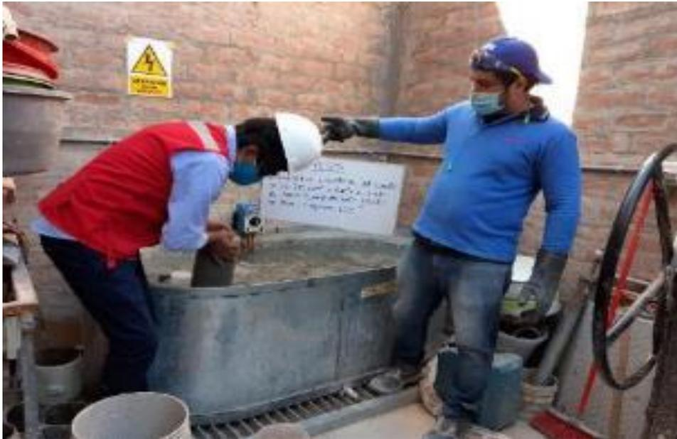
*Figura 16.* Curado de probetas en agua en 7, 14, 21 y 28. Días
