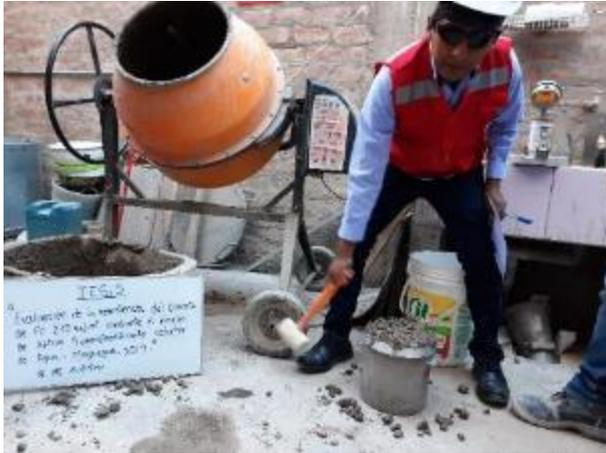
Figura 26. Ensayo para determinar el peso unitario del concreto siguiendo las normas astm C 138 - 09
