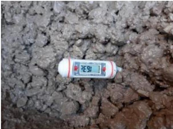
Figura 27. Se observa la toma de temperatura en estado fresco del concreto 210 kg/cm<sup>2</sup>
