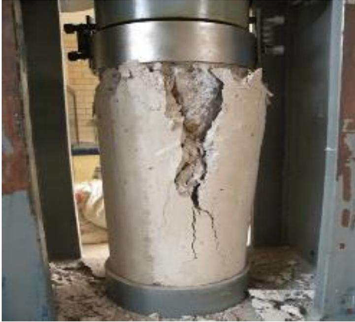
Figura 8. Ensayo de compresión axial en el concreto endurecido
