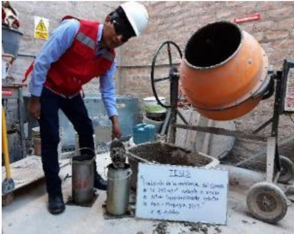
Figura 22. Llenado de probetas de concreto 210 kg/cm<sup>2</sup> con y sin aditivo, ASTM C 172 - 08
