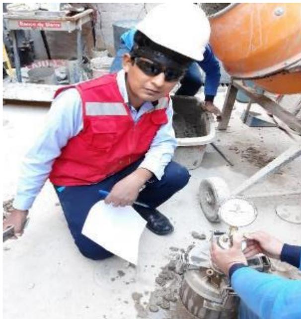
Figura 25. El contenido de aire de la muestra de concreto  $f'c$  210 kg/cm<sup>2</sup>
