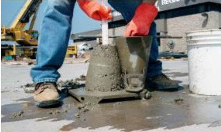
Figura 7. Ensayo de slump en el concreto fresco
