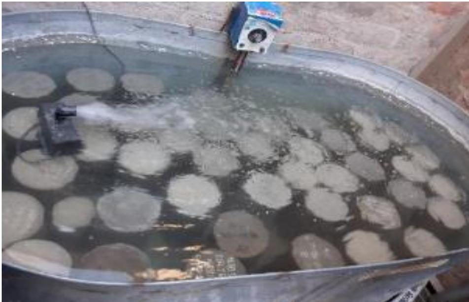
*Figura 17.* Curado de testigos de concreto con 0,5 % 1 % 1,5 % 2 % 3 % más el concreto patrón
