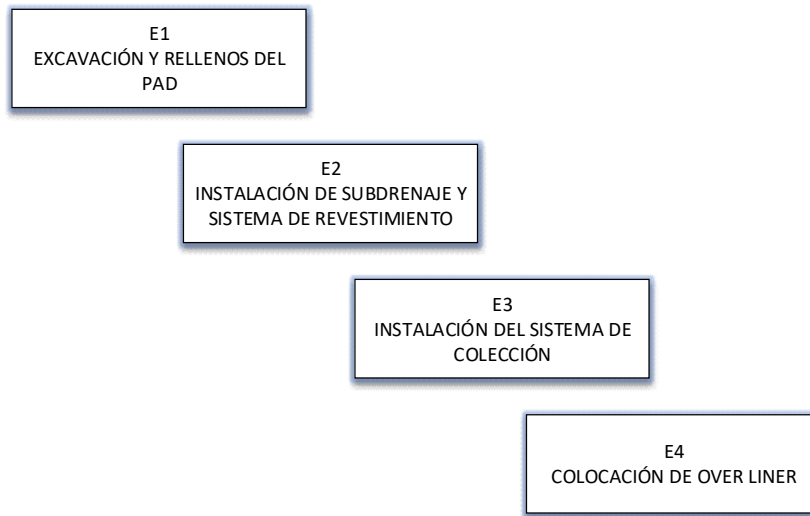
Figura 2. Etapas en la construcción del PAD de lixiviación.
