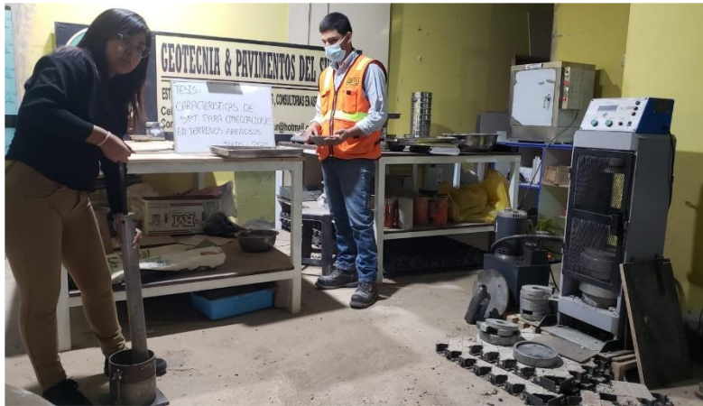
Figura 14. Uso de pisón metálico para ensayo Proctor
