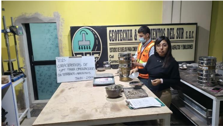
Figura 4. Ensayo de granulometría de arena por el método de tamizado
