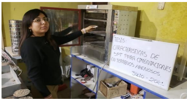
Figura 11. Colocado de muestra humedad al horno
