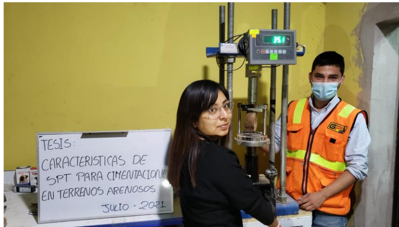
Figura 16. Muestra CBR sometida a prensa
