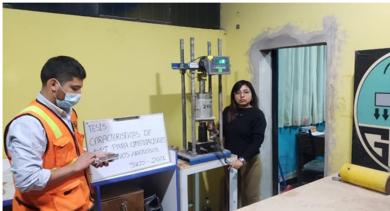
Figura 15. Molde CBR sometido a prensa
