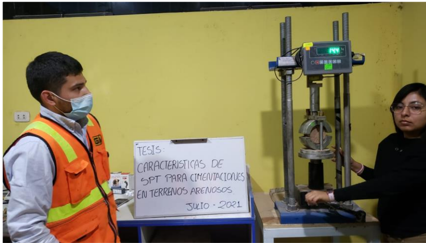
Figura 17. Muestra CBR sometida a presión en prensa
