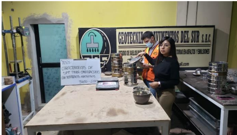
Figura 3. Ensayo de granulometría de grava por el método de tamizado
