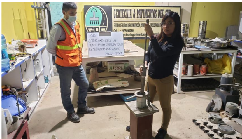
Figura 18. Compactación en ensayo CBR
