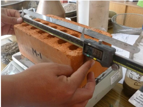
Figura 19. Procedimiento de medición de elementos de arcilla cocida.
