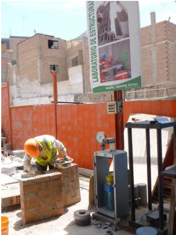
Figura 23. Pilas de las unidades de albañilería
