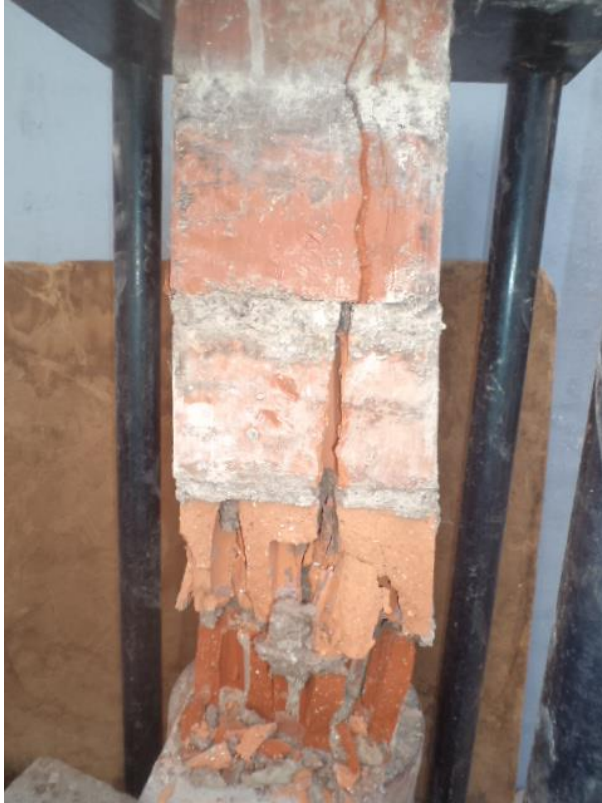
Figura 22. Unidades de albañilería sometidas al ensayo de compresión.
