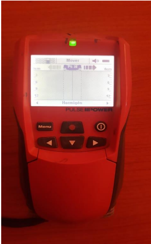
Figura 17. Detector de acero
