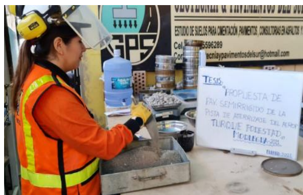
Figura 35. Ensayo de peso unitario
