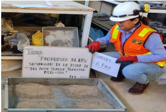
Figura 33. Ensayo de cuarteado de material
