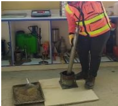
Figura 22. Uso de pisón metálico para ensayo Proctor
