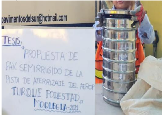
Figura 17. Ensayo de granulometría de Material Subrasante por el método de tamizado
