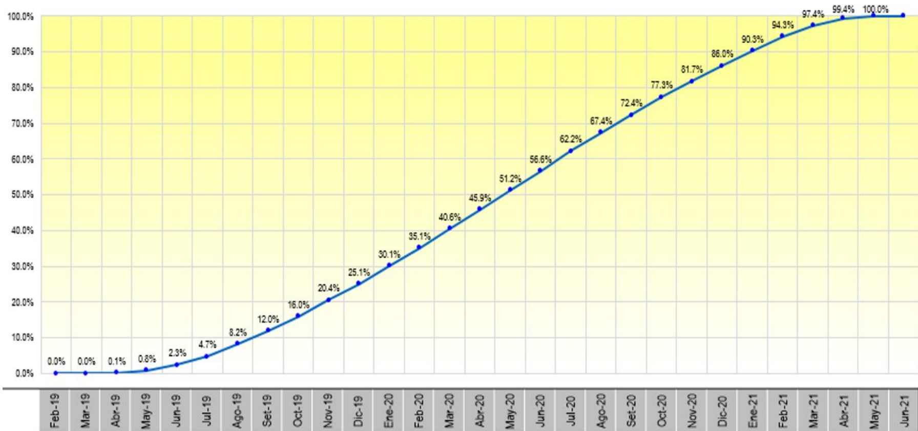
Figura 14. Curva “S” de la planta concentradora Quellaveco
