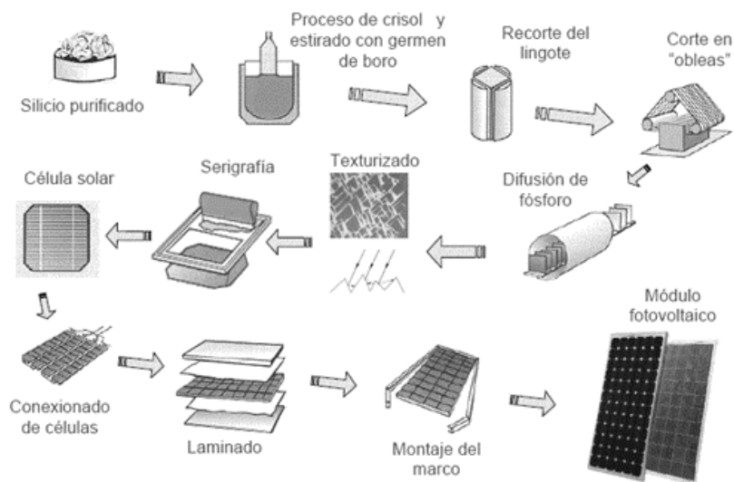
Figura 31. Fabricación de la célula y del módulo fotovoltaico
