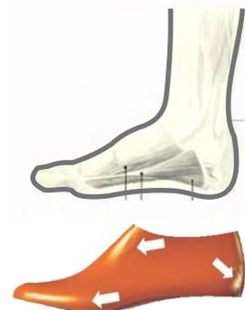
La horma se divide en tres partes, dos anteriores y la punta, en las dos terceras partes en el área de los metatarsos se apoya siempre, al igual en el dibujo se deberá considerar este punto de apoyo, habrá que considerar el alto del tacón y el spring para poder trazar el contorno inferior, la horma no es simétrica, de la mitad hacia atrás se encuentra la mesa, nunca en el eje de simetría.
