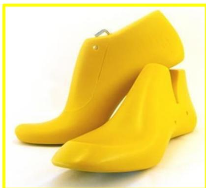
El empeine tiene una curvatura hacia afuera, es muy importante ya que esa línea define el contorno del calzado.
