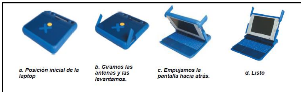
Figura 3: Pasos para abrir la laptop XO Fuente: “Manual básico de XO 1.5”, Fuzatti, s.f.: p. 4
