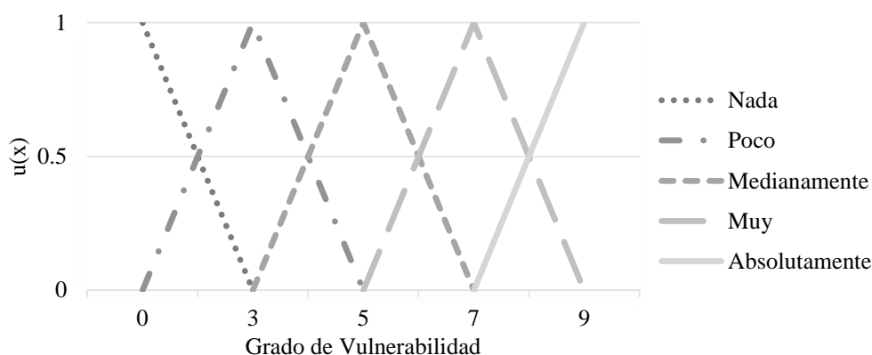
Figura 9. Representación de funciones de pertenencia de los grados de vulnerabilidad
